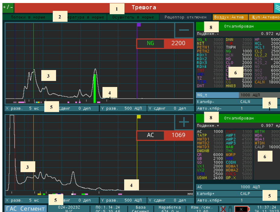
Рис. 2.17. Пользовательский интерфейс программного обеспечения Газосигнализатора, отображаемый на внешнем мониторе.
